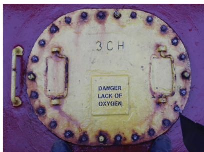
Slika 2. Brodski tank tereta s upozorenjem opasnosti od smanjenja razine kisika
